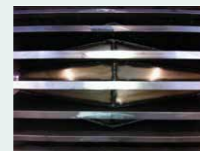
Nahaufnahme: Sterntrommel mit dem innenliegenden Doppelkonus
