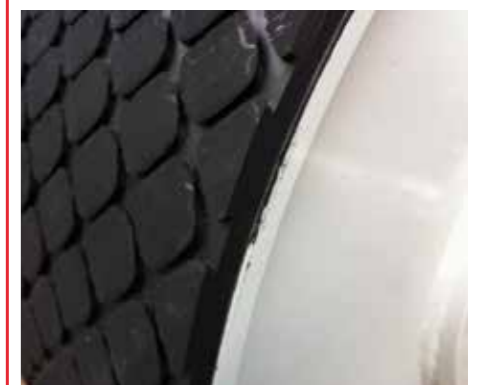
Mit Paste verschlossene Nahtstelle eines Gummi-Reibbelags
