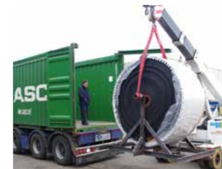
Verladung eines 8,2 t Polysur ® Ferro Elevatorgurts in einen oben offenen Container
