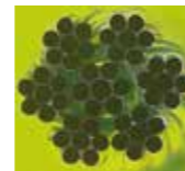
Kettseile aus konventionellen Stahlseilen
