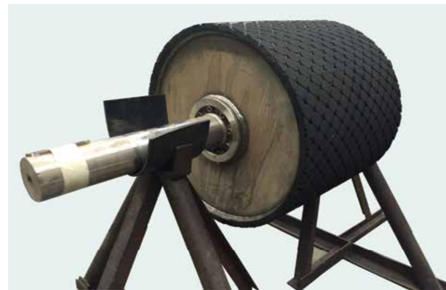
Mit Paste verschlossene Nahtstelle eines Gummi-Reibbelags
