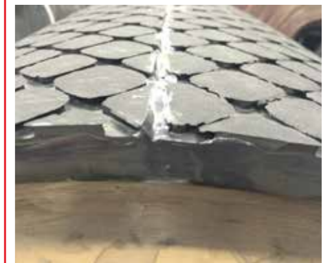
Mit Paste verschlossene Nahtstelle eines Gummi-Reibbelags
