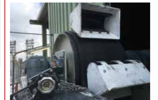
Nahaufnahme: Balligkeit der Rollenoberfläche
