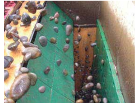
REDI-LINER™™ vol polyurethaan gemonteerd na zeefdek overstorpunt
