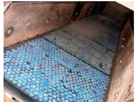
REDI-LINER™ type KT gemonteerd in glijgoot voor gerecycled asfalt
