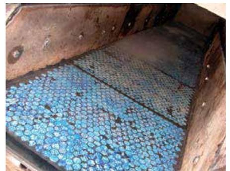
REDI-LINER™ Typ KT in einer Schurre für Recycling-Asphalt
