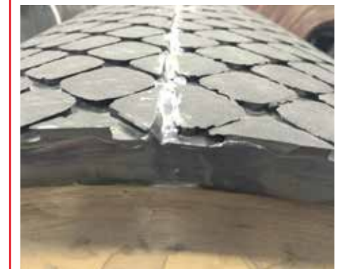
Mit Paste verschlossene Nahtstelle eines Gummi-Reibbelags
