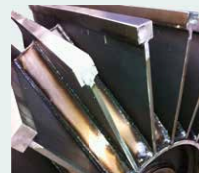
Nahaufnahme: Sterne mit den Auflageflächen für den Gurt
