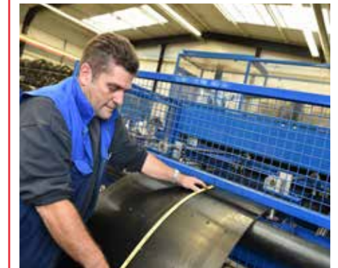
Polysur® EP Gummi-Elevatorgurt mit CNC gestanzten Löchern für in zwei Reihen versetzt angeordnete Elevatorbecher.
