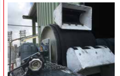
Nahaufnahme: Balligkeit der Rollenoberfläche
