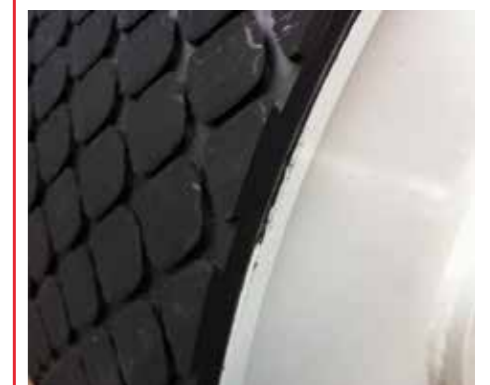
Mit Paste verschlossene Nahtstelle eines Gummi-Reibbelags
