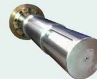
Welle mit zweistufigem Zapfen und Passfedernut
