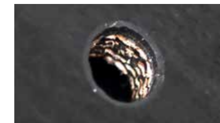
Close up van een CNC geponst elevatorboutgat in EP bewapende Polysur® rubber elevatorband.
