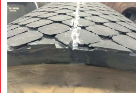
Detail van rubber ruitprofiel trommelbekleding v.z.v. afwerkingskit op de verbindingsnaad en zijkanten
