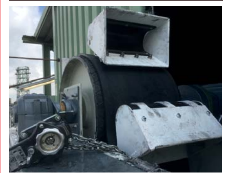
Close up bollering van het loopvlak op aandrijftrommel
