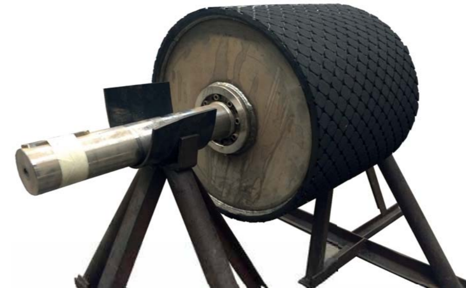
Detail van rubber ruitprofiel trommelbekleding v.z.v. afwerkingskit op de verbindingsnaad en zijkanten
