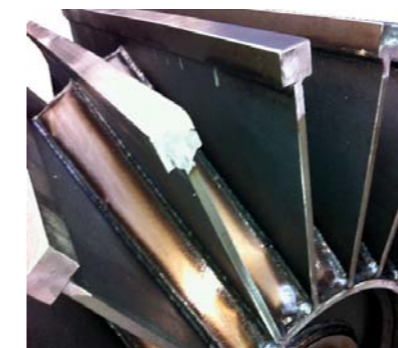
Detail van de vanen die de elevatorband ondersteunen
