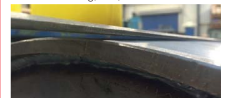
Close up bollering van het loopvlak op aandrijftrommel
