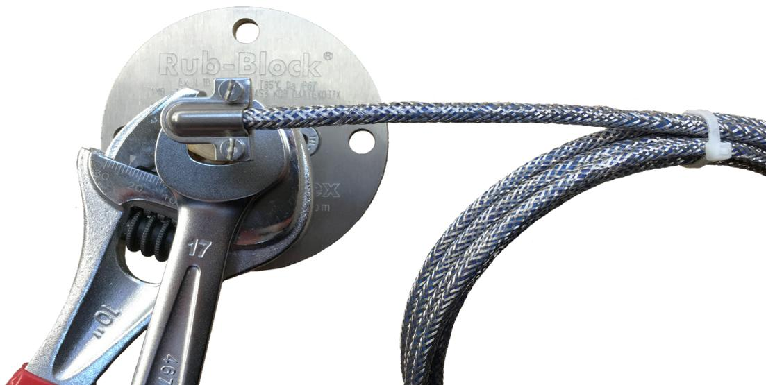
**Schritt 5:** Drehen Sie den Schraubenschlüssel (Größe 17) 1½ Umdrehungen im Uhrzeigersinn **BITTE NICHT ÜBERDREHEN.**
