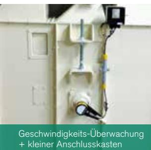
Geschwindigkeits-Überwachung + kleiner Anschlusskasten
