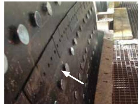
Auswechselbarer öl- und fettbeständiger Verschleißgummi auf dem Aluminiumkeil. Die Befestigung erfolgt mit zwei Schrauben mit Innensechskant.
