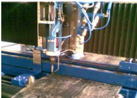
CNC-Bohrmaschine zum Bohren der Löcher für die Elevatorbecher und die Gurtklemmen in einem querarmierten Polysur® Ferro Stahlseil-Elevatorgurt.
