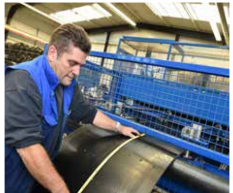
Polysur® EP Gummi-Elevatorgurt mit CNC gestanzten Löchern für in zwei Reihen versetzt angeordnete Elevatorbecher.
