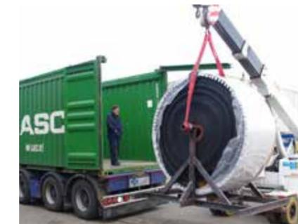
Verladung eines 8,2 t Polysur<sup>®</sup> Ferro Elevatorgurts in einen oben offenen Container
