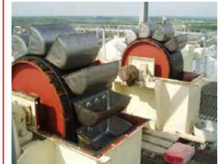
TECHNISCHE SPEZIFIKATION - SUPER STARCO STAHL ELEVATORBECHER
