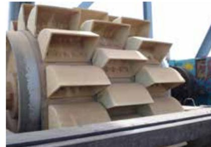
TECHNISCHE SPEZIFIKATION - TIGER-TUFF® KUNSTSTOFF ELEVATORBECHER
