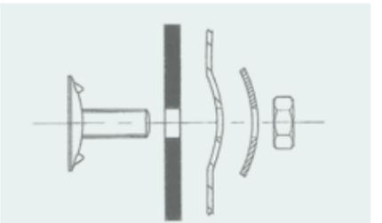
Montage eines Elevatorbeckers mit gewölbten Schraubenlöchern
