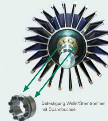
Befestigung Welle/Sterntrommel mit Spannbuchse
