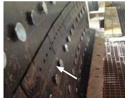
Auswechselbarer öl- und fettbeständiger Verschleißgummi auf dem Aluminiumkeil. Die Befestigung erfolgt mit zwei Schrauben mit Innensechskant.
