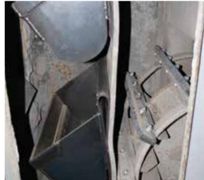
TECHNISCHE SPEZIFIKATION - GESCHWEISSTE DIN 15233 ELEVATORBECHER
