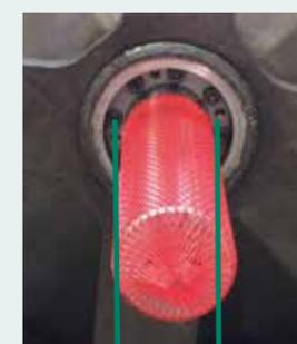
Befestigung Welle/Stabtrommel mit Spannbuchse
