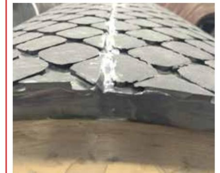
Mit Paste verschlossene Nahtstelle eines Gummi-Reibbelags
