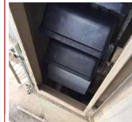
TECHNISCHE SPEZIFIKATION - PA-6G NYLON ELEVATORBECHER
