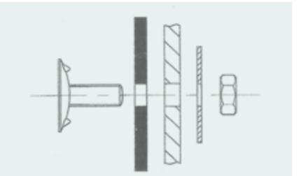
Montage eines Elevatorbeckers mit flachen Schraubenlöchern
