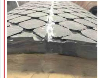
Mit Paste verschlossene Nahtstelle eines Gummi-Reibbelags
