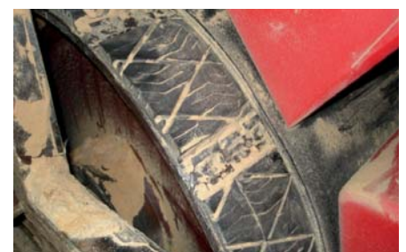
Close up van Slide-Lag trommelbekleding gelast op het loopvlak van de aandrijftrommel
