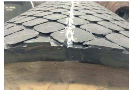
Detail van rubber ruitprofiel trommelbekleding v.z.v. afwerkingskit op de verbindingsnaad en zijkanalen
