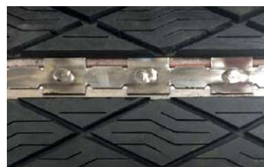
Close up van Slide-Lag trommelbekleding gelast op het loopvlak van de aandrijftrommel
