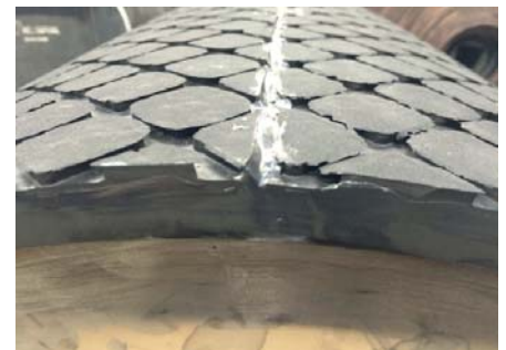
Detail van rubber ruitprofiel trommelbekleding v.z.v. afwerkingskit op de verbindingsnaad en zijkanten
