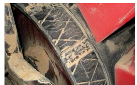
Close up van Slide-Lag trommelbekleding gelast op het loopvlak van de aandrijftrommel
