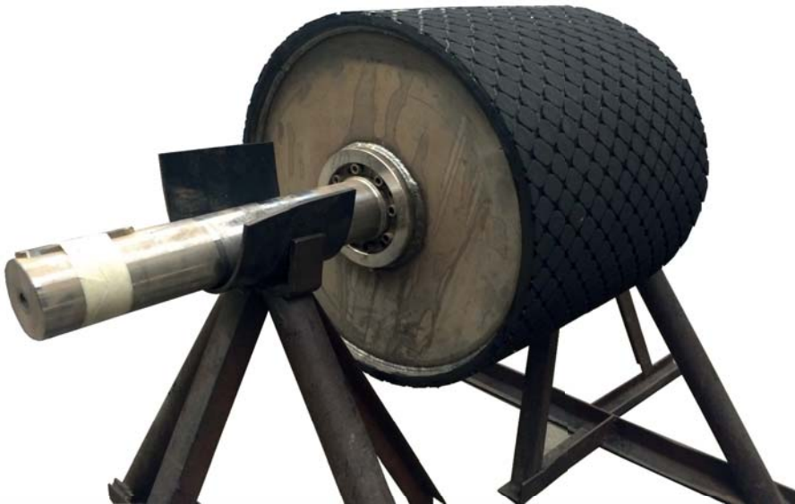
Detail van rubber ruitprofiel trommelbekleding v.z.v. afwerkingskit op de verbindingsnaad en zijkanten
