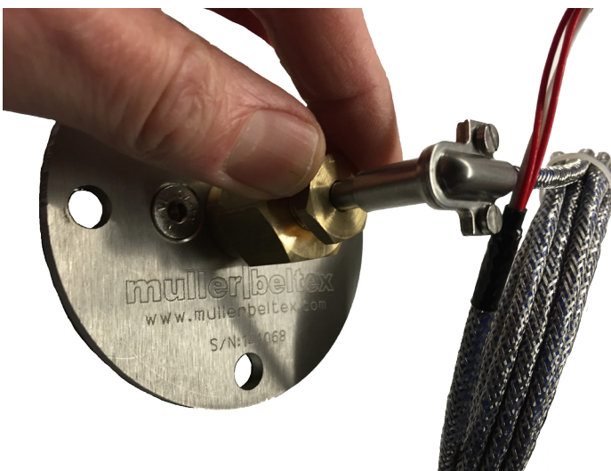
Stap 3: Draai de bout op de messing behuizing handvast
