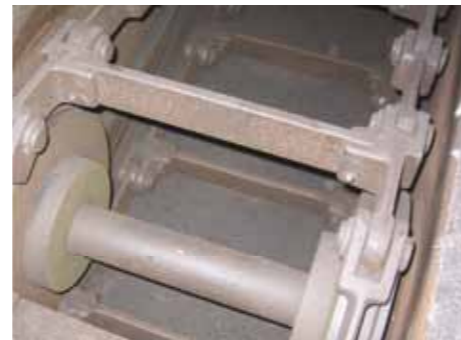
Voorbeeld van een toepassing met dubbele ketting bij het omkeerwiel
