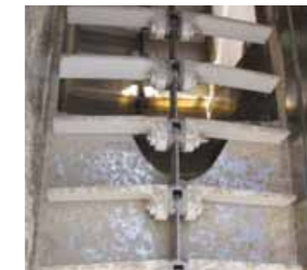
Bolt 'N' Go ketting met nylon meenemers in gebruik bij een veevoeder bedrijf
