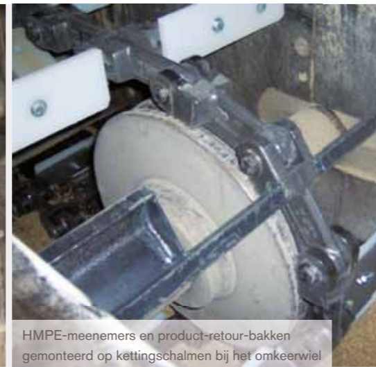
HMPE plaatjes gemonteerd op 'T'-style meenemers bij het kettingwiel
