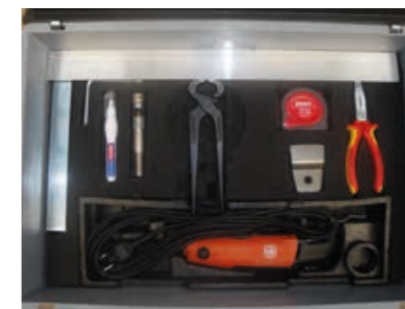
Kompl. Werkzeugkasten für die Vorbereitung des anderen Gurtendes auf der Baustelle zur Montage der Polysur® Solid Gurtverbinder
