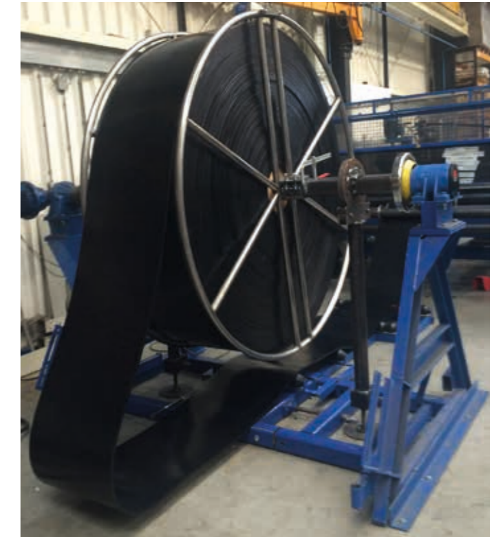
Abwickeln des Polysur® Ferro Gurts an der CNC-Gurtbohrmaschine
