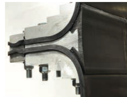
Muller Beltex Polysur® Solid Gurtverbinder mit Einfach-Klemmstück aus Stahl (Ansicht von der Laufseite des Gurts). Beachten Sie bitte den hitzebeständigen Gummi als Verschleißteil auf der zentralen Keilleiste des Gurtverbinders.
