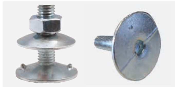
M12 Schraube DIN 15237 Klasse 4.6, verzinkt, mit Schraubenkopf Ø 42 mm und Innensechskant
