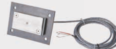
Rub-Block Gurtschleif-Sensor aus Edelstahl (erforderlich sind 2 Stck. auf jeder Seite im Becherwerkskopf und 2 Stck. auf jeder Seite im Becherwerksfuß)
