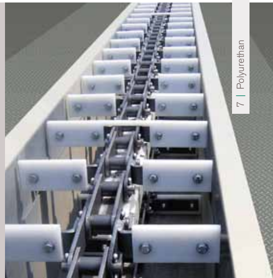
Bodenplatten für Kettenförderer – Kryptane® schwarz
