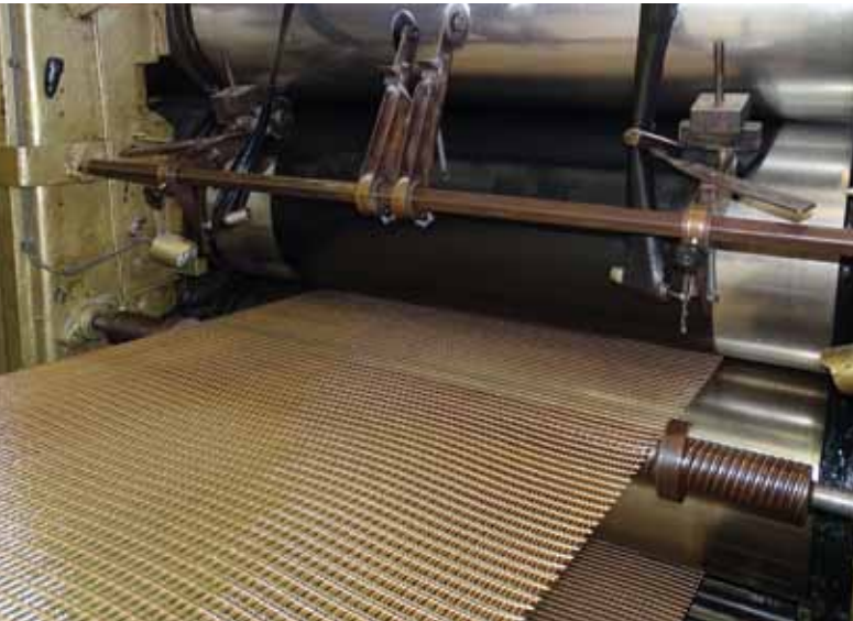
Herstellung einer Fleximat® Stahlgewebe-Verstärkung
